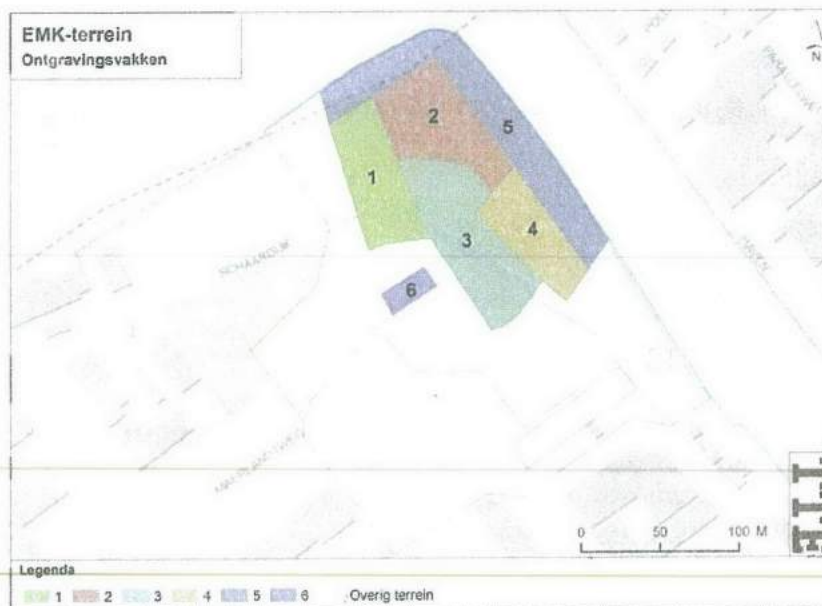
Figuur 3. Af te graven vakken tijdens de sanering. Om de verspreiding van geur te bepalen is gebruik gemaakt van de uiterste punten van de vakken 1, 3, 5 en 6.
