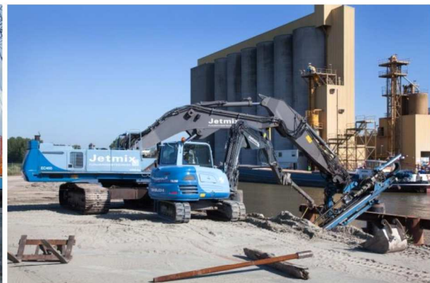
3.4 Ankerboormachine op basis van hydraulische graafmachine met hulpkraan
