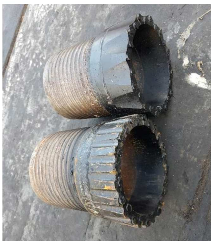
Figuur 5 Boorkop voor doorboren van oude damwand
