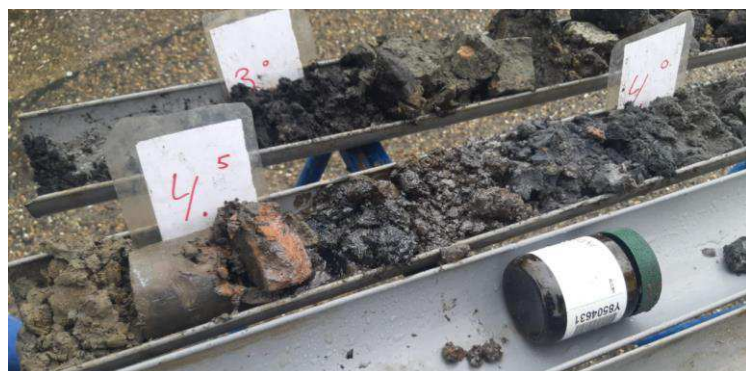
Verontreinigde zandlaag van 4 tot 4,5 m- mv
