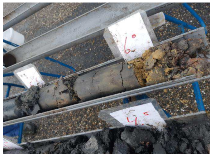
Fundering op 6 m- mv (gele baksteen)
