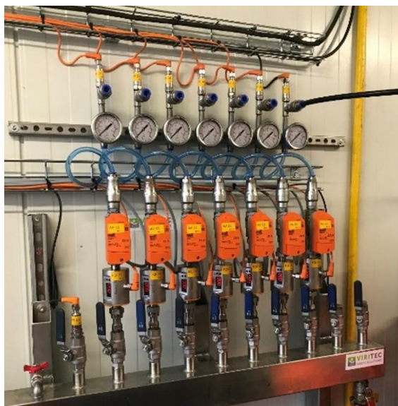
Beeld: kolomopstelling voor testen van PFAS adsorptie stoffen op het voormalig EMK-terrein.
