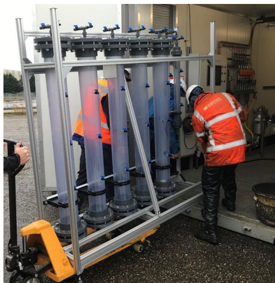
Beeld: kolomopstelling voor testen van PFAS adsorptie stoffen op het voormalig EMK-terrein.
