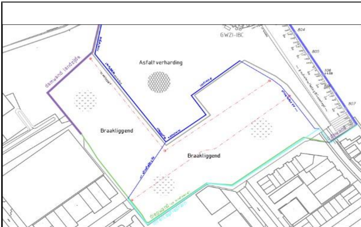
Figuur 3.3: Twee nieuwe drains (rode stippellijnen) zijn aangelegd na hevige regenval in oktober
