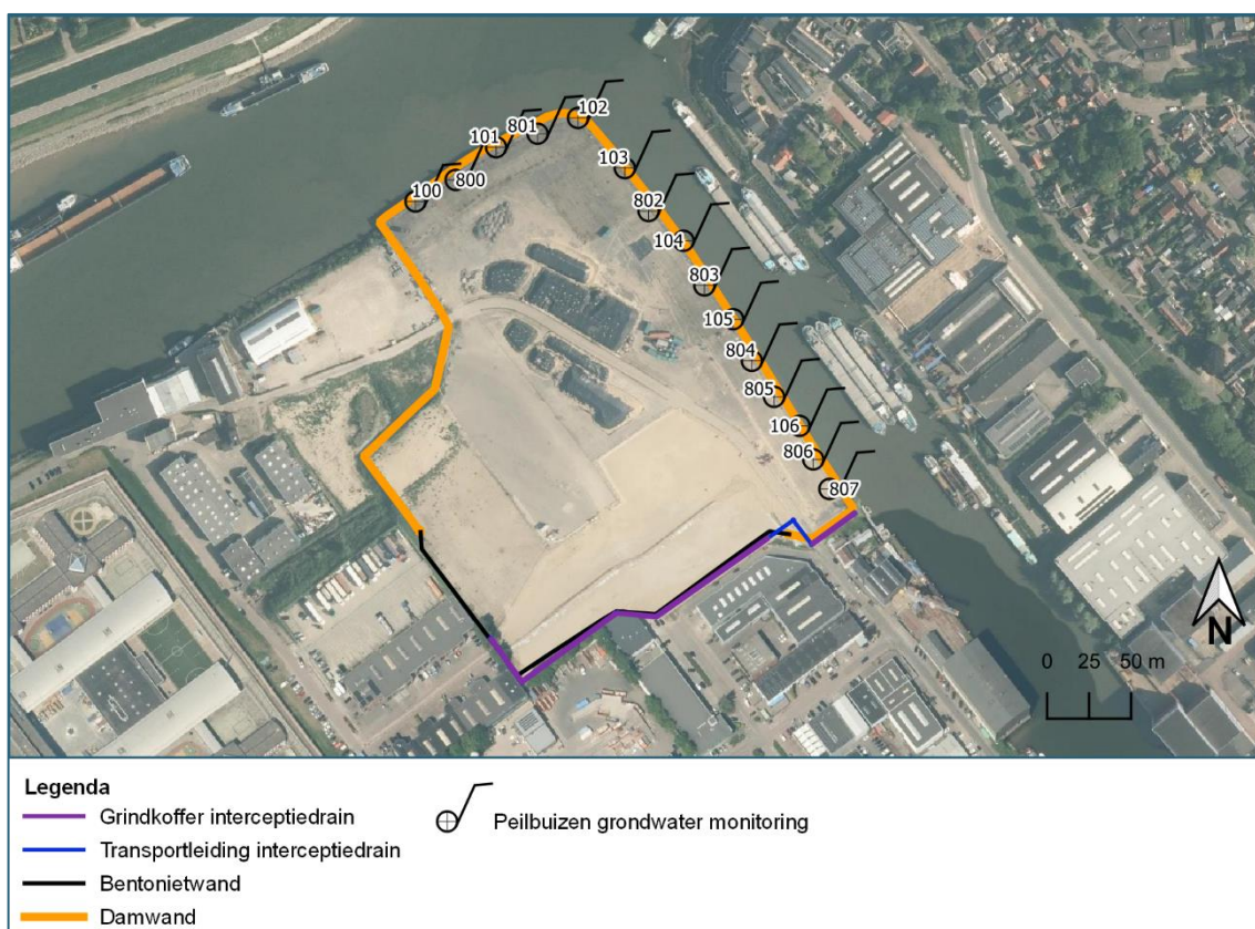
Figuur 2.2: Peilbuizen monitoring grondwaterstand
